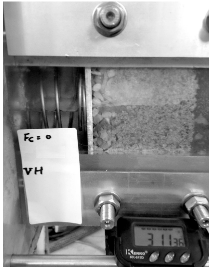
شکل ۱۱. حالت ترک خوردگی قائم و جریان افقی.
