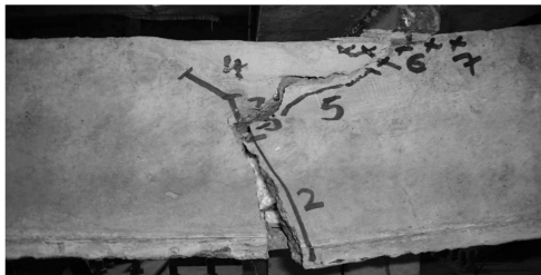
د) مد شکست در نمونه ۳. شکل ۱۰. بار نهایی و مد شکست.
