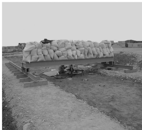
شکل ۳. تصویر سیستم گاری و ریل‌های مدولار.
