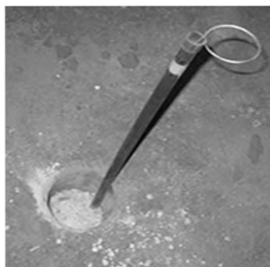
ب) نمونه یک پایه سنگریزه‌یی کامل شده که زه و غلاف زه متصل به صفحه نشانه مرجع از آن بیرون آمده است؛
