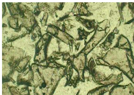
شکل ۲. عکس میکروسکوپ نوری از مقطع نازک سر باره با بزرگ‌نمایی ۴۰ برابر.
