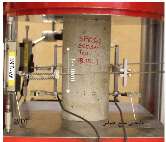
شکل ۴. چیدمان آزمایش فشار تک محوری برای برآورد رفتار تنش-کرنش فشاری ECC.
