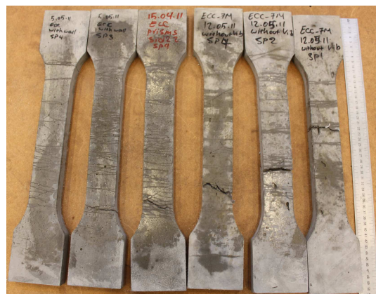
شکل ۷. ترک‌خوردگی متعدد نمونه‌های کششی و تمرکز ترک.
