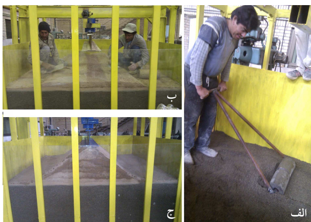
الف) نمایش چگونگی متراکم‌سازی بستر ماسه‌ای؛
