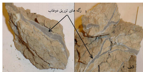
الف) رگه‌های تزریق دوغاب مکانیکی خاک؛
