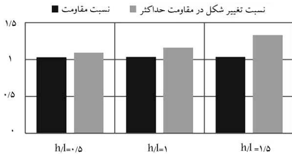
شکل ۱۰. مقایسه‌ی نسبت مقاومت و تغییرشکل در مقاومت بیشینه‌ی مدل‌های با المان مرزی محصورشده به مدل‌های با المان مرزی محصورنشده.
