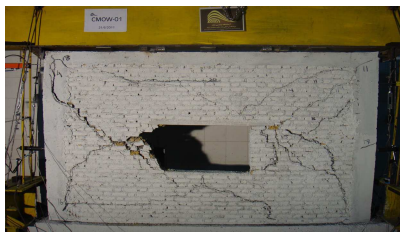
شکل ۱۴. تصویر نمونه دوم (CMOW-۰۱) پس از گسترش ترک‌ها.
