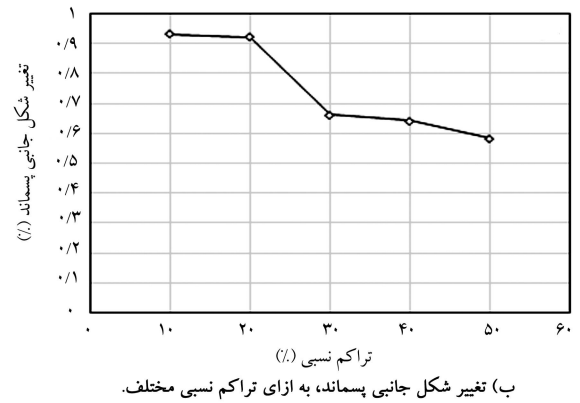
شکل ۱۱. تغییر شکل‌های جانبی سازه به ازای تراکم نسبی مختلف خاک ماسه‌یی سست با وقوع روان‌گرایی.
