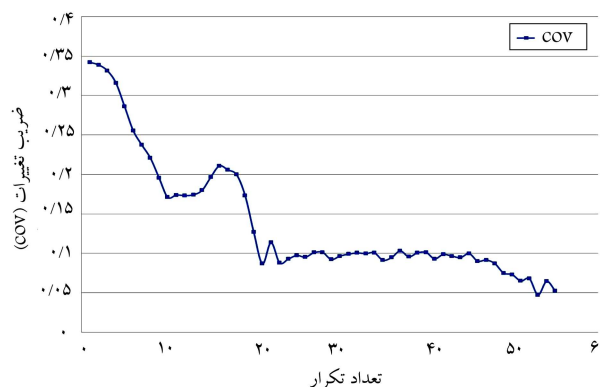
شکل ۱۰. روند کاهش ضریب تغییرات بیشینه‌ی تغییرمکان نسبی بین طبقه‌ی قاب ۹ طبقه‌ی منظم مجهز به میراگر تحت زلزله‌ی Northridge.
