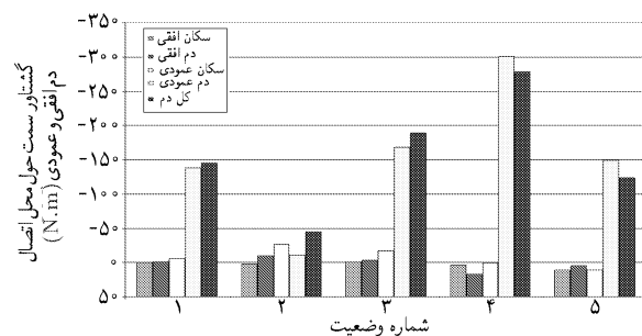
شکل ۱۴. گشتاور سمت وارد بر اجزای مختلف دم در پنج حالت مختلف.
