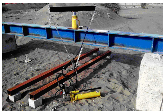
شکل ۶. نمایی از تجهیزات سیستم اعمال نیروی کششی به شمع.
