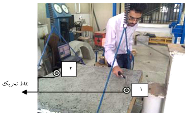
شکل ۱۱. تحریک عرشه توسط چکش مودال در نقاط تحریک ۱ و ۲.
