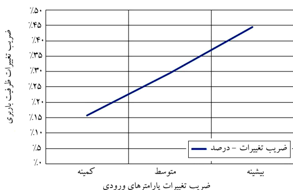
شکل ۱۲. تأثیر ضریب تغییرات پارامترها در ضریب تغییرات ظرفیت باربری در یک حالت از ترکیب پارامترها.
