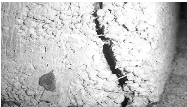
شکل ۷. تأثیر الیاف در محدود کردن عرض ترک در شالوده‌ی سبک.
