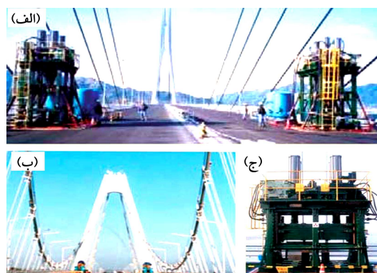
شکل ۴۰. آزمایش مودال تجربی پل کابلی.
