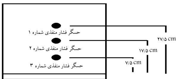
شکل ۲. محل قرارگیری حسگرهای فشار آب منفذی.
