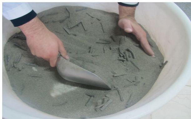
شکل ۷. نمونه سازی با توزیع تصادفی الیاف.
