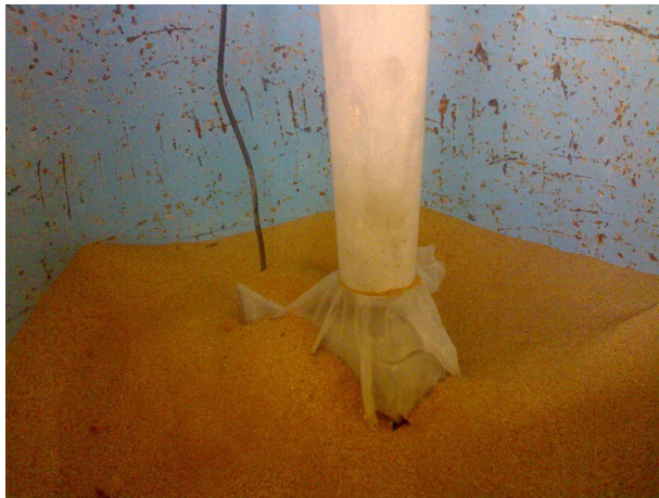
شکل ۷. نحوه‌ی قرارگیری شمع بر روی نیروسنج.
