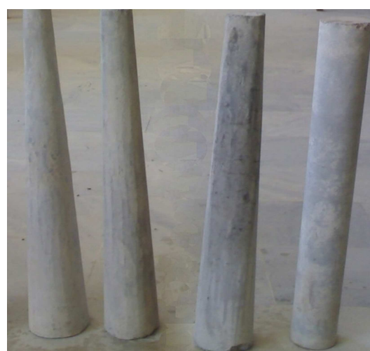
شکل ۲. تصویر شمع‌های ساخته شده.
