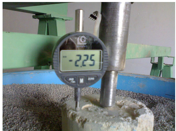
شکل ۶. محل قرارگیری نشست‌سنج روی سر شمع.
