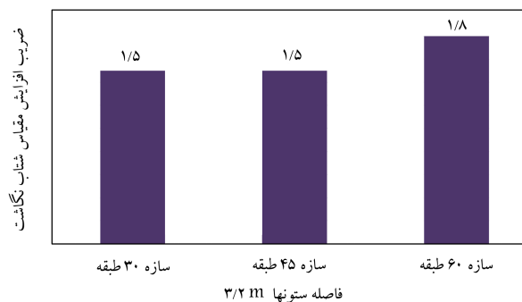
شکل ۱۷. مقایسه‌ی بیشینه‌ی شتاب‌نگاشت قابل تحمل در سازه‌های لوله در لوله‌ی فولادی مدل با فاصله‌ی ستون‌های ۳/۲ متر.
