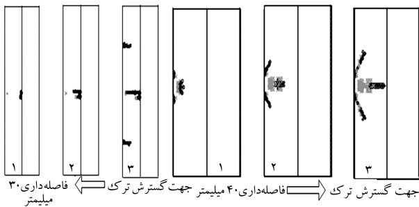
شکل ۳. تغییر جهت گسترش ترک در فاصله‌داری ۴۰ میلی‌متر.
