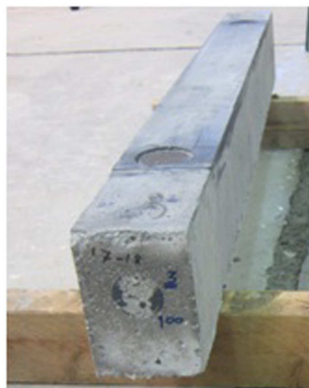
شکل ۷. محل نصب استوانه‌ی فلزی جهت اندازه‌گیری مقاومت چسبندگی به روش «پپچش».
