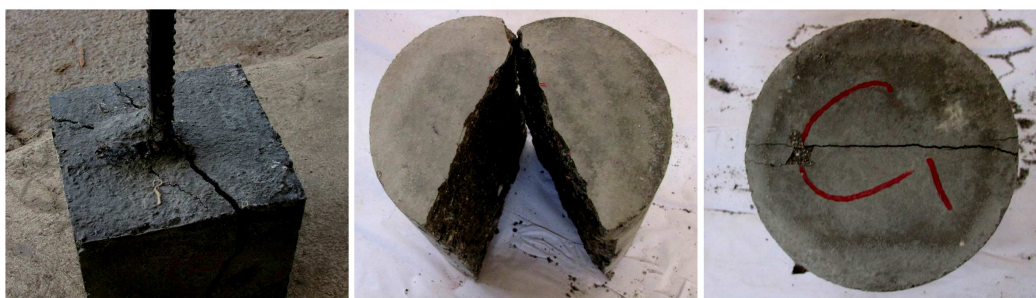
شکست نمونه در آزمایش چسبندگی / شکست نمونه فاقد الیاف در کشش / شکست نمونه با الیاف در کشش
