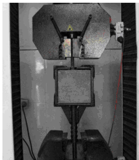
شکل ۳. دستگاه کششی آرماتورها در آزمایش مقاومت چسبندگی.
