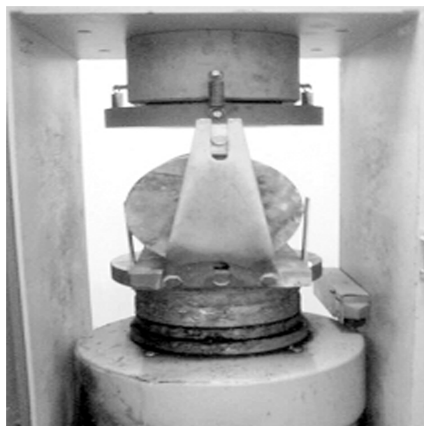
شکل ۸. نحوه انجام آزمایش مقاومت کششی به روش برزلی.
