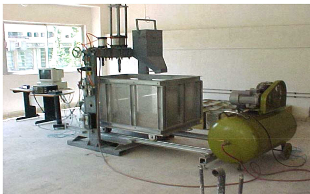
شکل ۲. مدل آزمایشگاهی اندازه‌گیری رانش سیکلی وارد بر دیوار حائل. [۸]
