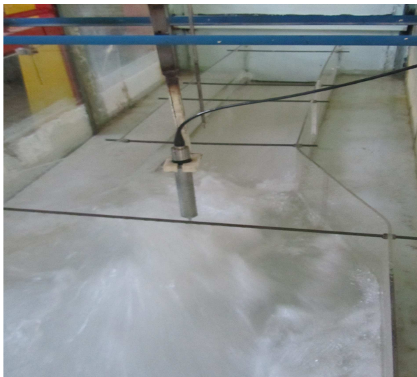
شکل ۴. تشکیل پرش هیدرولیکی در تبدیل s شکل.
