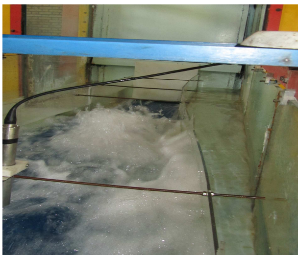
شکل ۵. تشکیل پرش هیدرولیکی در تبدیل با دیواره‌ی مستقیم.
