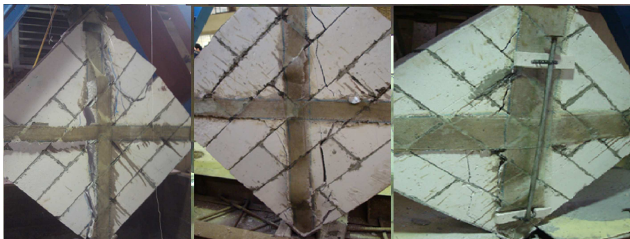
شکل ۹. نحوه‌ی شکست نمونه‌های تقویت‌شده با FRP.
