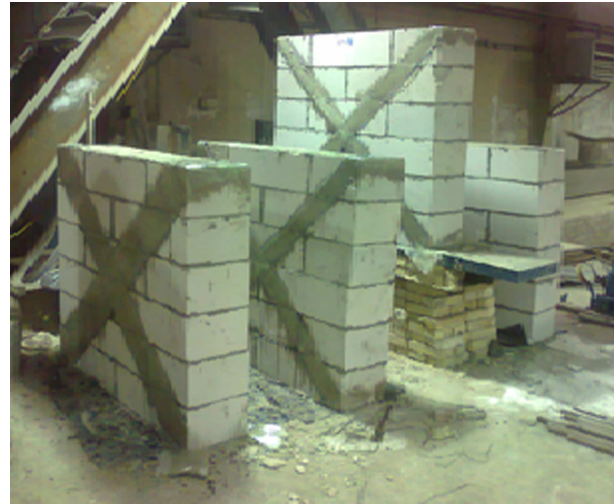
شکل ۶. نمونه‌ی دیوارهای مقاوم‌سازی شده با الیاف پلیمری.
