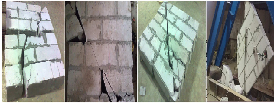
شکل ۷. نحوه‌ی شکست در نمونه‌ی دیوارهای مورد آزمایش کشش قطری.
