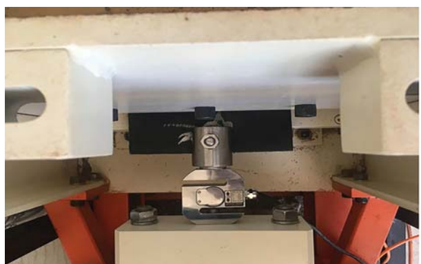
شکل ۷. اتصال گیره به جک هیدرولیک.
