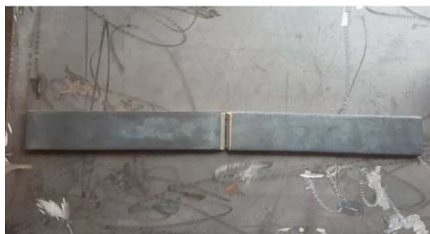
شکل ۴. آماده سازی نمونه های کششی برای جوشکاری.
