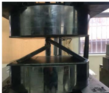
شکل ۲۴. یکی از نمونه‌های خمشی در هنگام شروع آزمایش.
