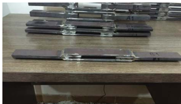
شکل ۱۲. نمونه‌های آماده شده‌ی آزمون برش جوش با ورق اصلی ۱۰ میلی‌متر.
