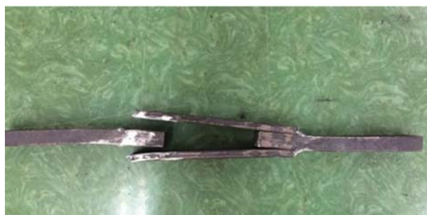
شکل ۲۲. نمونه ی برشی با جوش اکسی استیلن و الکترو د برنجی (بعد از انجام آزمون).
