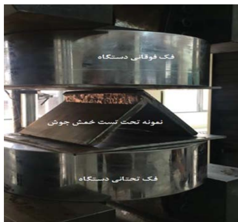
شکل ۱۹. دستگاه یونیورسال در حال آزمون یکی از نمونه‌های خمشی.
