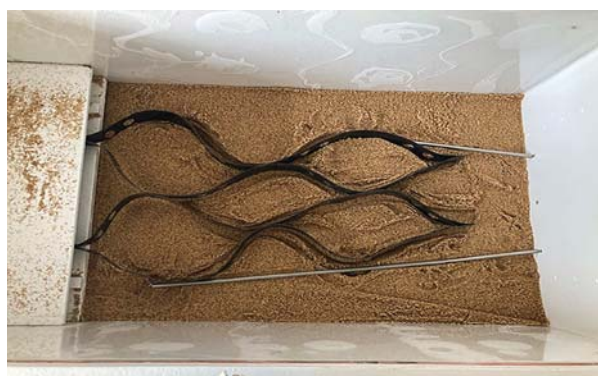
شکل ۴. قرارگیری ژئوسل روی نیمه‌ی پایینی مصالح خاکی.
