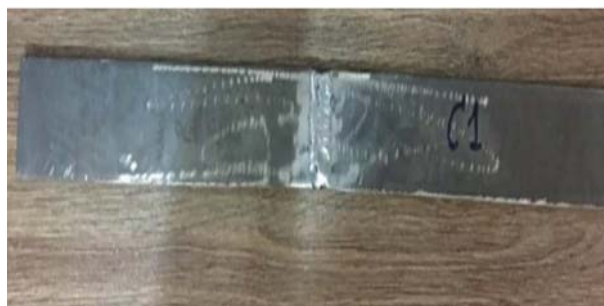
شکل ۷. نمونه‌ی کششی جوشکاری شده به روش قوس الکتریکی با الکتروود فولادی.
