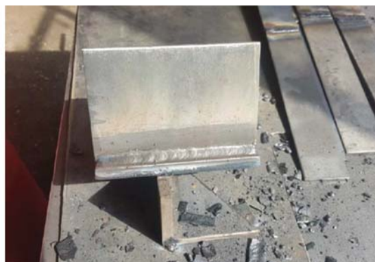
شکل ۱۵. جوش‌کاری نمونه‌های آزمون خمش در حالت تخت.
