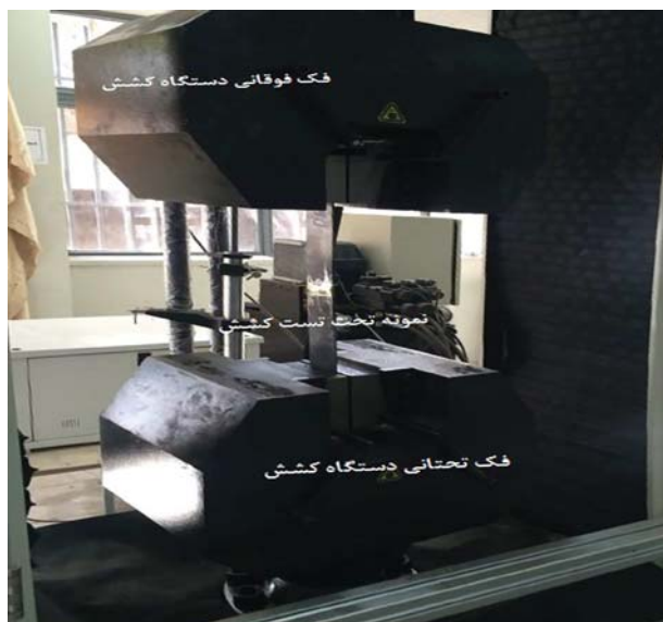
شکل ۱۷. دستگاه یونیورسال در حال آزمون یکی از نمونه‌های کششی.
