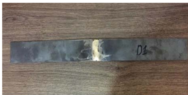
شکل ۶. نمونه‌ی کششی جوشکاری شده به روش اکسی استیلن با الکتروود برنج.
