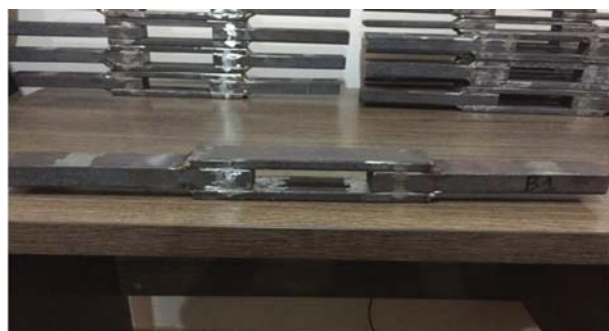
شکل ۱۱. نمونه‌های آماده شده‌ی آزمون برش با ورق اصلی ۲۰ میلی‌متر.
