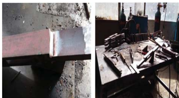
شکل ۱۰. جوشکاری نمونه‌های آزمون برش در حالت تخت.
