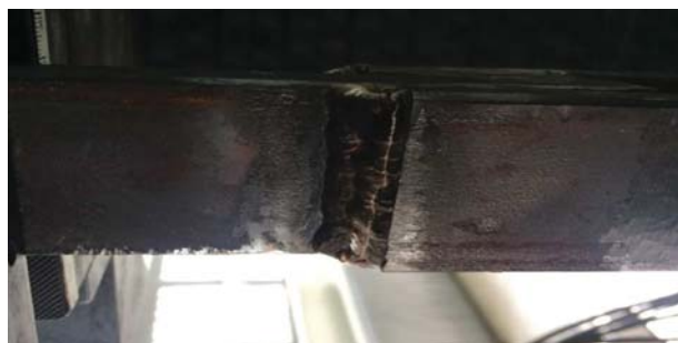
شکل ۲۱. تشکیل ترک و رشد آن در روی خط جوش در نمونه ی برشی.
