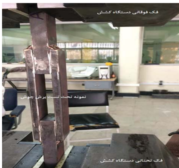
شکل ۱۸. دستگاه یونیورسال در حال آزمون یکی از نمونه‌های برشی.
