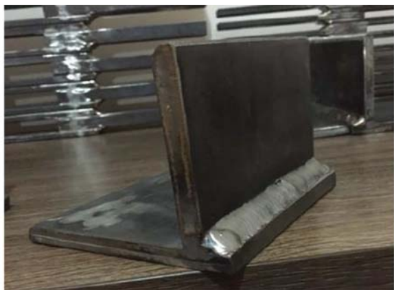
شکل ۱۶. نمونه‌ی آماده شده برای آزمون خمش.
