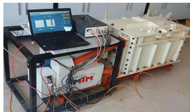
شکل ۲. دستگاه بیرون کشش استفاده شده ی مصالح خاکی و ژئوسل.
