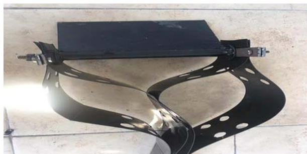
شکل ۵. گیره‌ی طراحی شده و متصل شده به ژئوسل.
