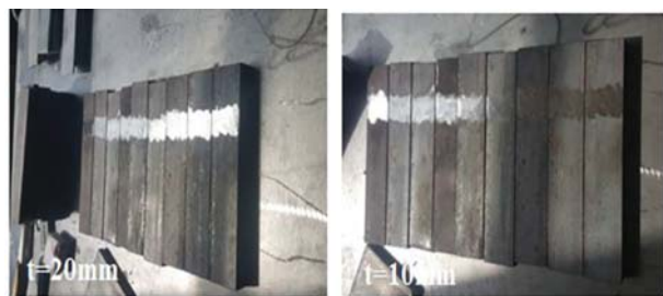
شکل ۸. ورق‌های اصلی با ضخامت‌های ۱۰ و ۲۰ میلی‌متر برای آزمون برش جوش.
