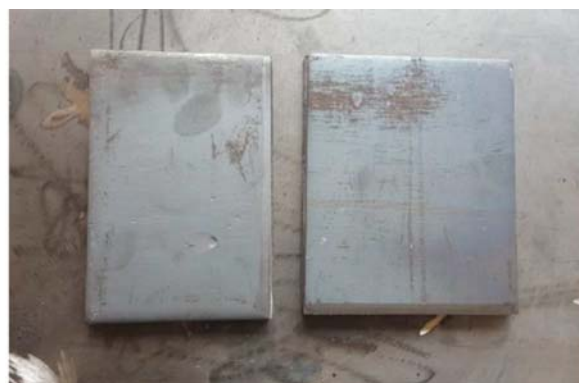
شکل ۱۳. ورق‌های با ضخامت ۱۲ میلی‌متر برای نمونه‌ی خمشی قبل از جوشکاری.
