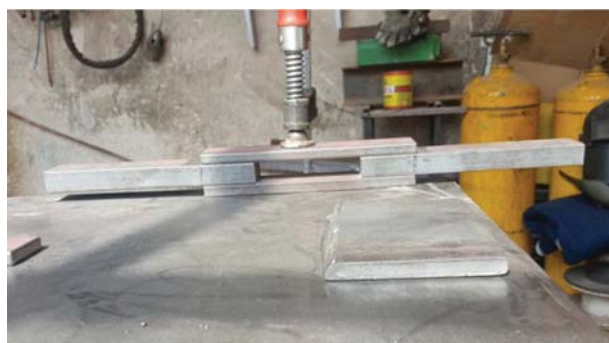
شکل ۹. آماده‌سازی نمونه‌های برشی برای جوشکاری.
