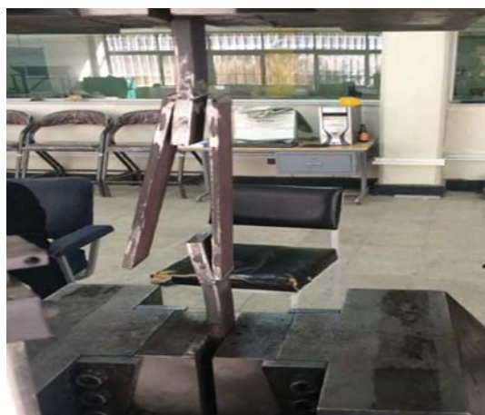
شکل ۲۳. یکی از نمونه های برشی با ضخامت ۱۰ میلی متر بعد از انجام آزمون.
