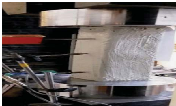
شکل ۸. نمونه‌ی ستون DHM مقاوم‌سازی‌شده با CFRP.
