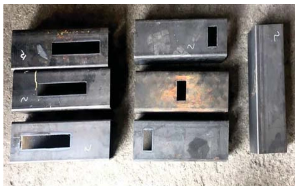
شکل ۳. تصاویر نمونه‌های سالم و نقص‌دار در کارخانه پس از برش CNC محل نقص.
