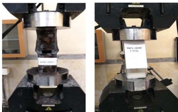
شکل ۱۲. بارگذاری نمونه‌های ۷۰۰ درجه سانتی‌گراد بدون تقویت و با تقویت خارجی.
