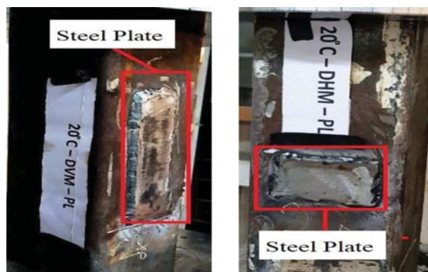
شکل ۹. نحوه‌ی مقاوم‌سازی نمونه‌ها به وسیله‌ی ورق‌های فولادی.
