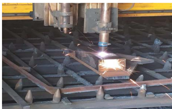
شکل ۲. تصاویر برش CNC نمونه‌ها در کارخانه.
