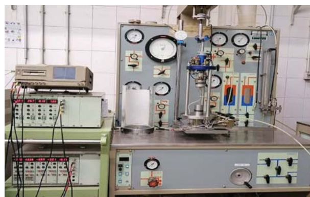
شکل ۱. دستگاه سه‌محوری و تجهیزات آن.
