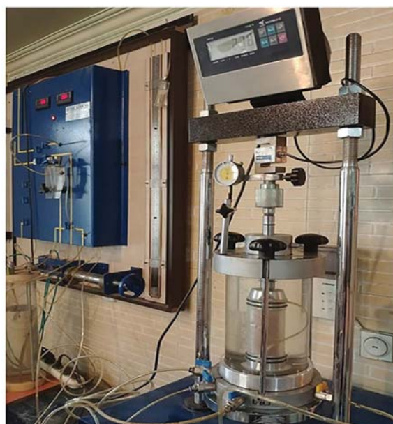
شکل ۲. نمای دستگاه سه‌محوری.
