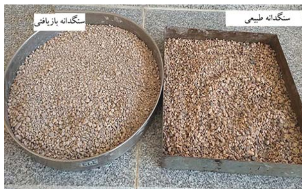
شکل ۷. درشت دانه‌ها پس از آزمایش لس آنجلس.
