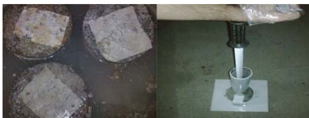
شکل ۹. آزمایش ضربه بر روی نمونه‌های دیسکی.
