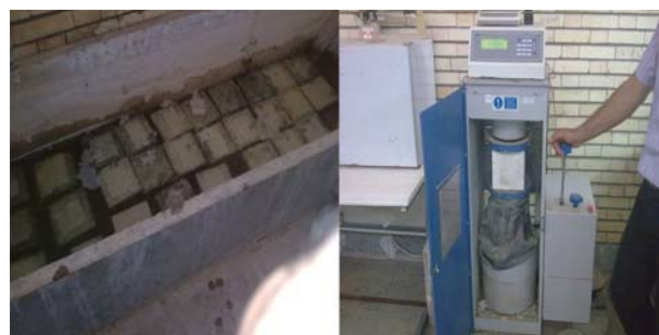
شکل ۷. آزمایش مقاومت فشاری بر روی نمونه‌های مکعبی.
