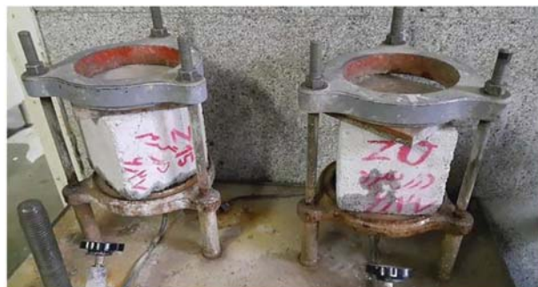
شکل ۵. قرارگیری نمونه‌ها در دستگاه آزمایش عمق نفوذ آب.
