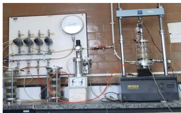
شکل ۸. تصویری از انجام آزمایش نفوذپذیری به کمک دستگاه سه محوری در آزمایشگاه.
