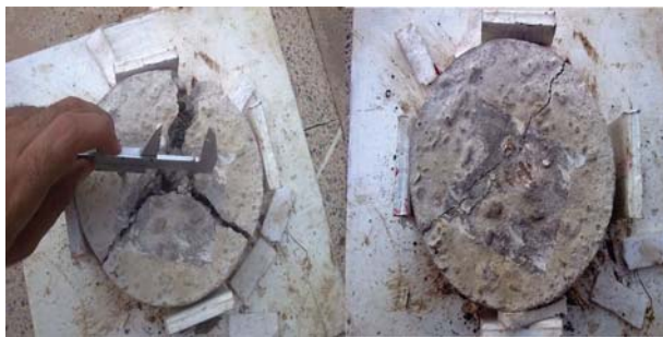
شکل ۸. شکست قطری نمونه‌ی بتن معمولی و شکست قطاعی نمونه با سبک‌دانه.
