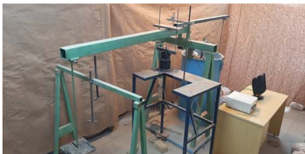
شکل ۵. دستگاه ارزیابی پتانسیل ریمبندگی با قابلیت مدل‌سازی الگوی نفوذ آب.
