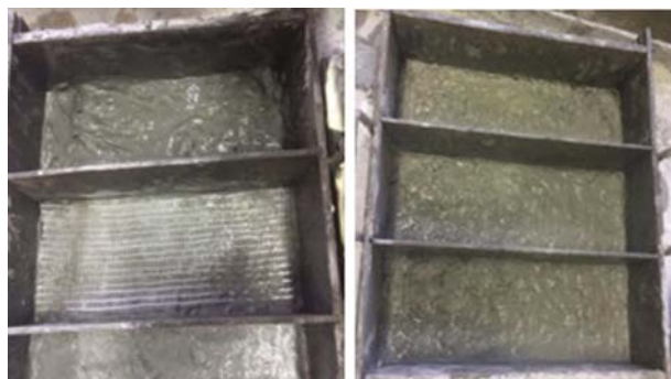
شکل ۲. نحوه‌ی ساخت پانل‌های ECC مسلح به بافته‌های شیشه.
