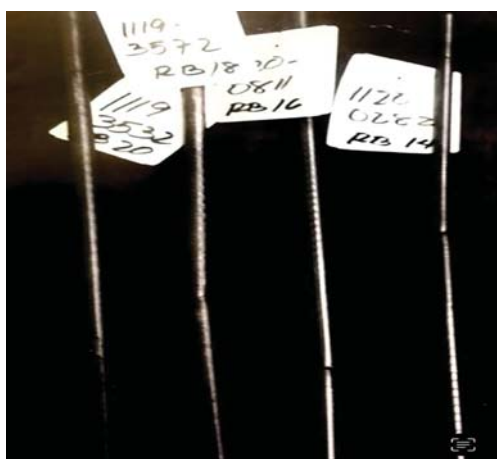
شکل ۲. نمونه‌ی میلگردهای استفاده شده برای انجام آزمایش‌های مکانیکی، که در آنها ازدیاد طول نسبی ایجاد شده و شکست اتفاق افتاده است.
