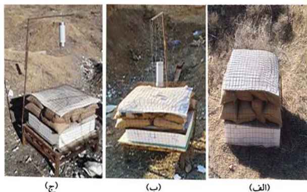
شکل ۵. الف) آزمایش ۱، ارزیابی پنل به صورت انفجار تماسی؛ ب) آزمایش ۲، ارزیابی پنل با فاصله‌ی ۰/۲ متری در انفجار، ج) آزمایش ۳، ارزیابی پنل با فاصله‌ی ۱ متری در انفجار.
