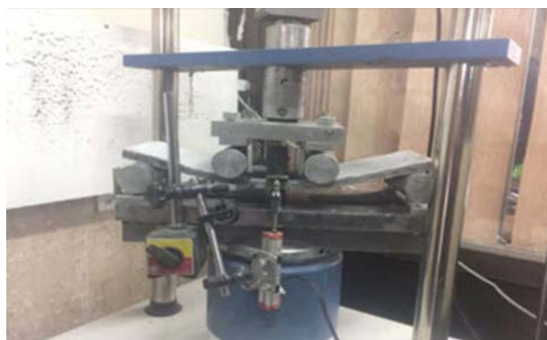
شکل ۷. پانل ECC مسلح شده به بافته‌های شیشه تحت آزمایش خمش.
