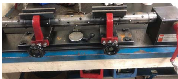
شکل ۶. دستگاه نشانه‌زنی میلگرد برای اندازه‌گیری و آماده‌سازی میلگرد برای آزمایش‌های کششی.
