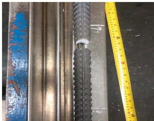
شکل ۵. اندازه‌گیری ازدیاد طول نسبی مناسب در نقطه‌ی شکست.
