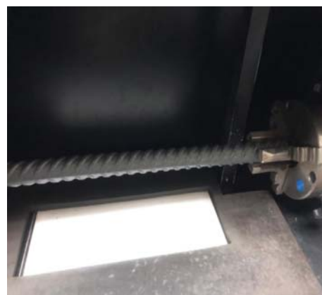
شکل ۱۰. دستگاه لیزری برای اندازه‌گیری ابعاد هندسی میلگرد آجدار.
