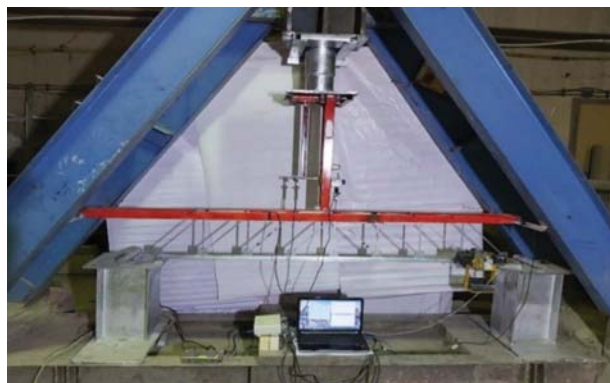
شکل ۱. نمونه‌ی پل خرابایی ساخته شده در آزمایشگاه.
