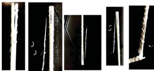
شکل ۱۰. نحوه‌ی شکست میلگرد فیبری.
