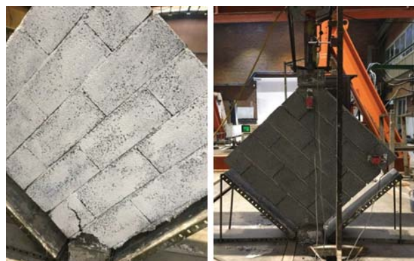
شکل ۲. الف) تنظیمات آزمون کشش قطری (برش) و ب) مد شکست فشاری پنجه.
