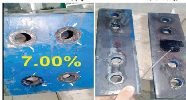
ج) سوراخ های ورق های فیوز بال تیر در ۷٪ رادیان؛ د) سوراخ های بال تیر پس از باز کردن ورق های فیوز بال.
