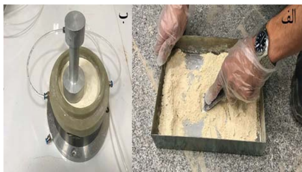
شکل ۳. الف) آماده سازی نمونه خاک با ترکیب رس، آب و شیرابه و ب) ساخت نمونه در قالب آزمایش بر اساس روش کنترل حجم و بهره گیری از کوبش مرطوب.
