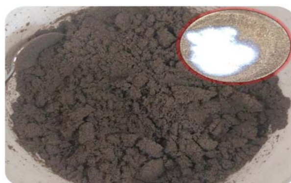
شکل ۵. ترکیب ماسه به همراه پلیمر.
