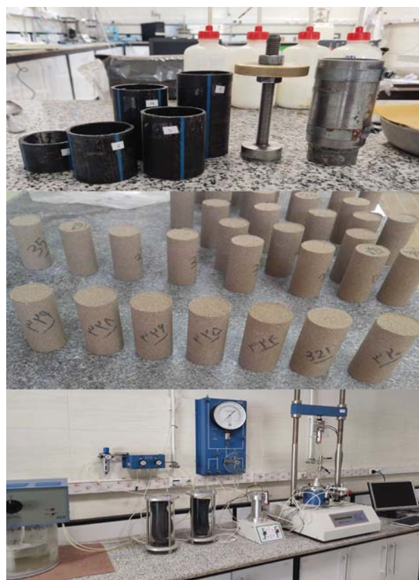
شکل ۷. تجهیزات ساخت و نمونه‌های ساخته شده و دستگاه سه‌محوری استاتیکی و استفاده شده.
