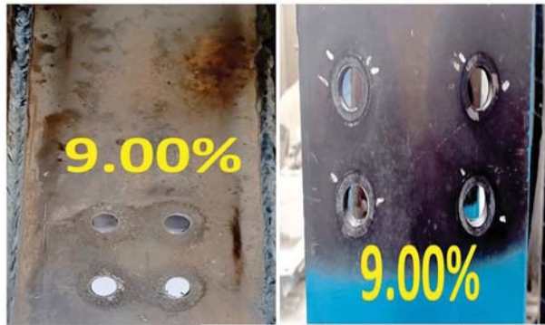
ج) سوراخ های پیچ بر روی بال تیر در د) سوراخ های پیچ بر روی جان تیر در انتهای آزمایش؛
