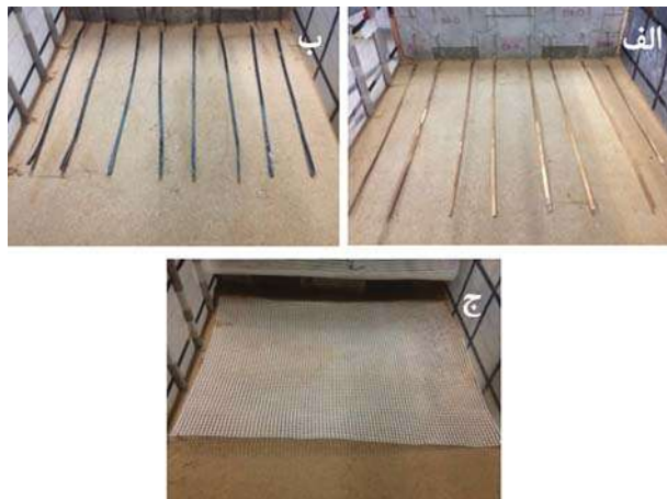
شکل ۲. المان‌های مورد استفاده در بدنه مدل‌ها (الف) تسمه فلزی، (ب) تسمه پلیمری (ج) ژئوگرید.
