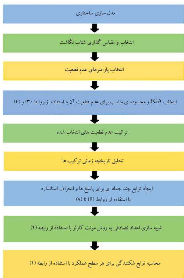
شکل ۲. مراحل استخراج منحنی شکنندگی با روش پیشنهادی SI-HDMR.
