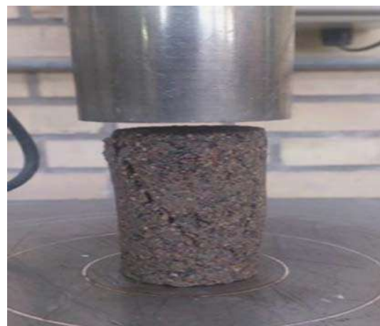
شکل ۶. شکست برشی نمونه در دستگاه تک‌محوری.
