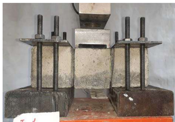
شکل ۶. نمونه‌ی بتنی تحت اعمال نیروی برشی.
