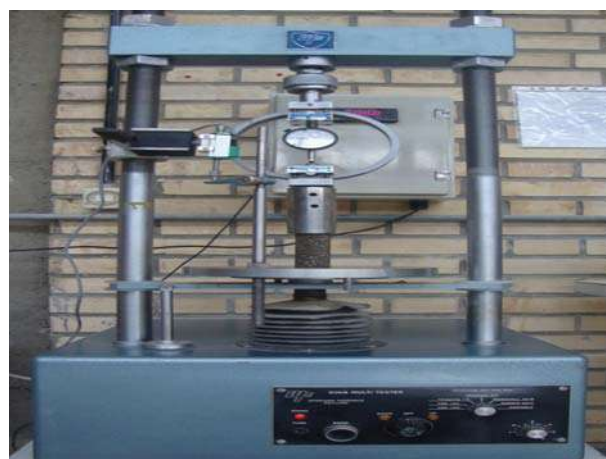
شکل ۳. دستگاه انجام آزمایش تک محوری محصور نشده UCS.
