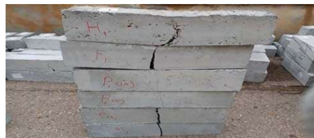
شکل ۱۲. مقایسه‌ی انهدام نمونه‌های با نسبت آب به سیمان W/c = 0.29 .
