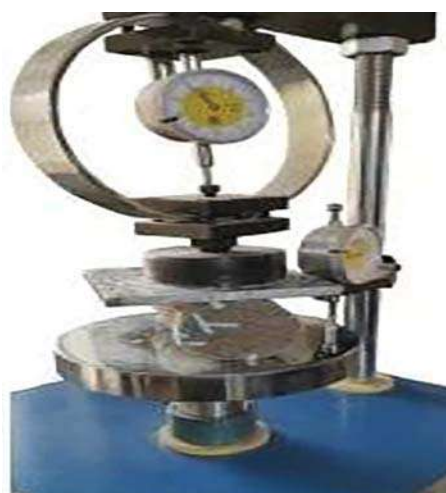
شکل ۲. نحوه‌ی قرارگیری نمونه‌ها و انجام آزمایش کشش غیرمستقیم برزیلی.
