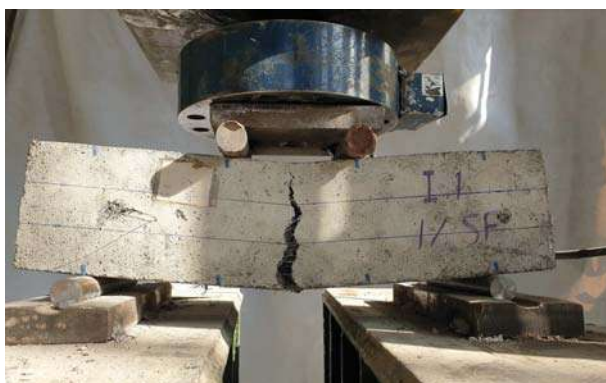
شکل ۴. نمونه‌ی بتنی تحت خمش.
