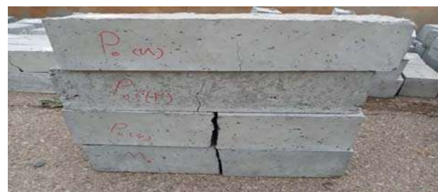
شکل ۱۱. مقایسه‌ی انهدام نمونه‌های با نسبت آب به سیمان W/c = 0.24 .
