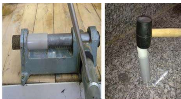
الف) قالب نمونه، چکش و میله تفلونی جهت کوبش؛ ب) دستگاه بیرون آورنده نمونه تک محوری از قالب.
