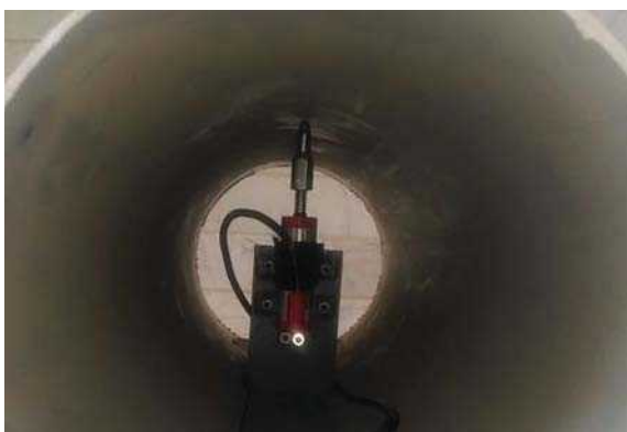
شکل ۲. تصویری از حسگر سنجش تغییر مکان و نصب آن داخل لوله.
