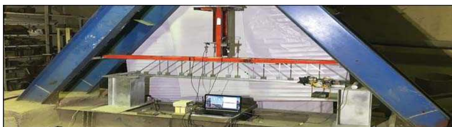
شکل ۱. پل خرابایی دو بُعدی ساخته شده در آزمایشگاه سازه.
