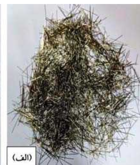
شکل ۳. الف) میکرو الیاف فولادی؛ ب) میکرو الیاف پلی پروپیلن.
