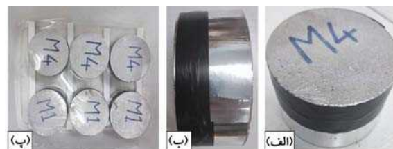
شکل ۳. الف) نمای سه بعدی سطح جانبی و فوقانی نمونه‌ی عایق بندی شده؛ ب) نمای جانبی؛ پ) تصویر آزمایش جذب آب مویینه.
