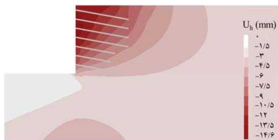
شکل ۸. کانتور تغییر شکل افقی مدل مرجع در انتهای تحلیل استاتیکی.
