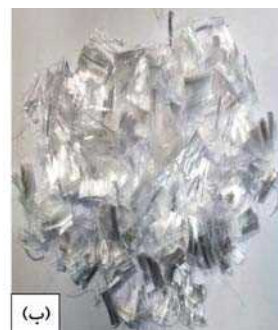
شکل ۳. الف) میکرو الیاف فولادی؛ ب) میکرو الیاف پلی پروپیلن.
