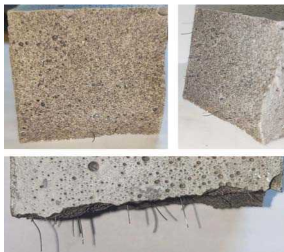
شکل ۷. بافت کامپوزیت سیمانی M۵ پس از آزمایش خمشی سه نقطه‌یی.
