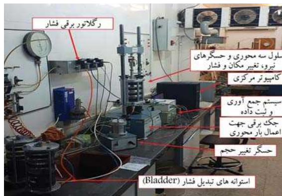
شکل ۲. نمایی از دستگاه سه محوری غیراشباع ارتقاء یافته. [۲۸ و ۲۹]
