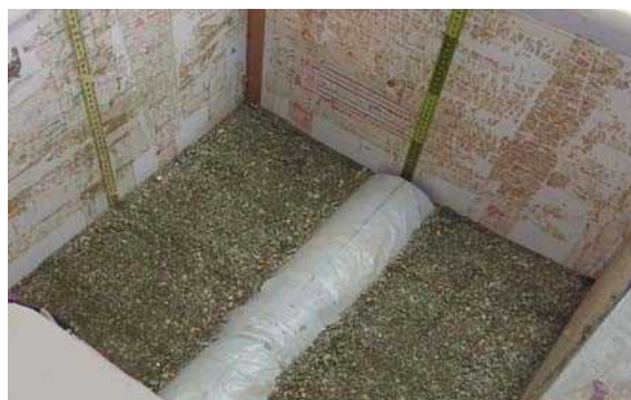
شکل ۳. تصویری از لوله حین آماده‌سازی آزمایش.
