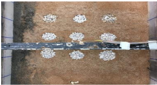
شکل ۴. نمای پلان گروه سنگی ساخته شده (نسبت ابعاد مدل به ابعاد نمونه‌ی واقعی: ۱ به ۱۲).
