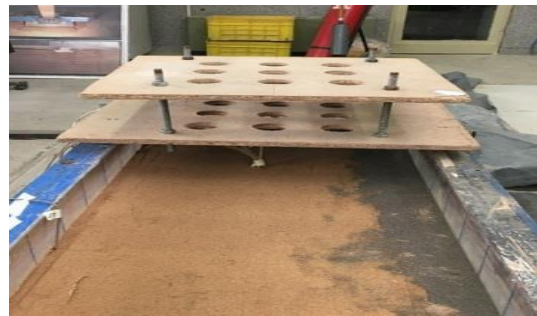
شکل ۳. شابلون استفاده شده جهت ساخت ستون‌های سنگی.
